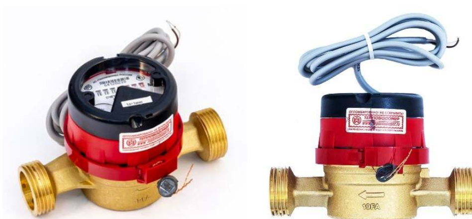
е) внешний вид счётчиков исполнений ВСХд-15-02, ВСХд-20-02, ВСГд-15-02, ВСГд-20-02 на примере ВСХд-15-02 и ВСГд-15-02 (внешне ВСХд отличаются от ВСГд цветом элементов корпуса, соответственно, синий и красный)
